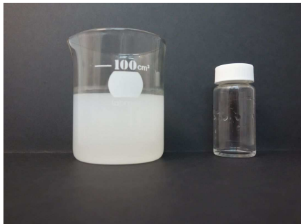
Rys. 27. Efekt Ouzo w układzie Etanol – Toluen – Woda
