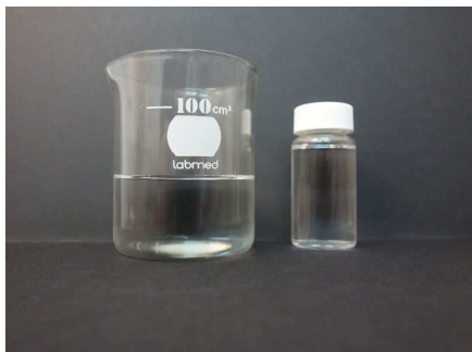
Rys. 27. Efekt Ouzo w układzie Etanol – Toluen – Woda
